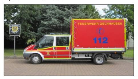
Die Sondersignalanlage wurde komplett in der langlebigen & stromsparenden LED Technik ausgeführt. Zusätzlich wurde eine Heckwarneinrichtung mit vier gelben LED Blinkleuchten angebaut. Zur besseren Wahrnehmbarkeit im Dunkeln wurde das Fahrzeug mit einer Reflexbeklebung ausgestattet. Diese reflektiert die auftreffenden Lichtstrahlen wie in den Vergleichsbildern ersichtlich und sorgt somit für mehr Sicherheit an den Einsatzstellen selbst bei völligem Elektrikausfall.
